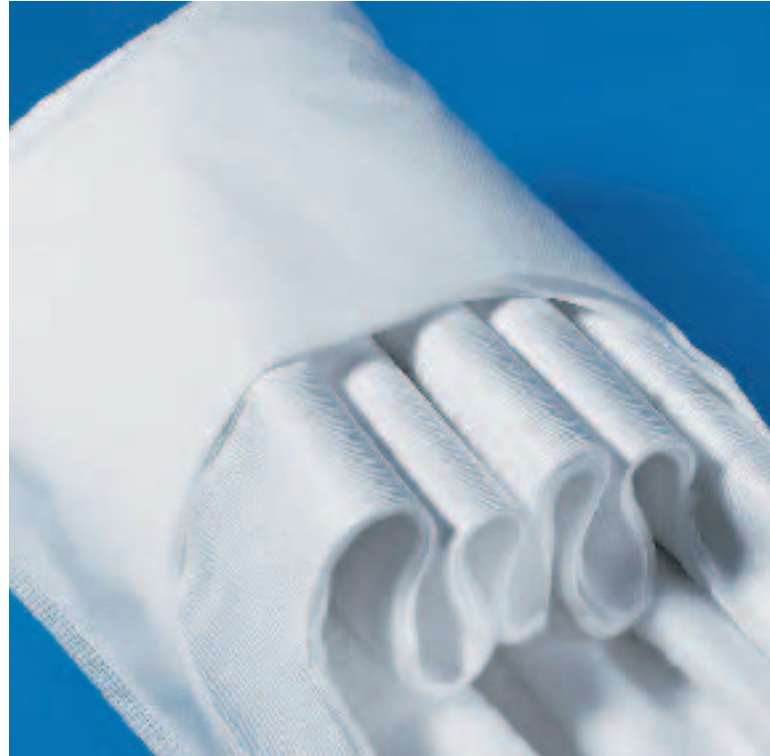
Un préfiltre plissé procure une très grande surface (environ 3 m 2 ) pour recueillir gels et solides avant qu'ils n'atteignent les couches du filtre de finition.
